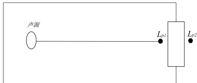
图 4-1 室内声源等效为室外声源的图例
