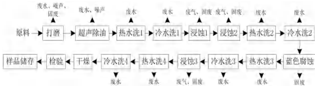
图 2-2 项目主要工艺流程及产污环节图
